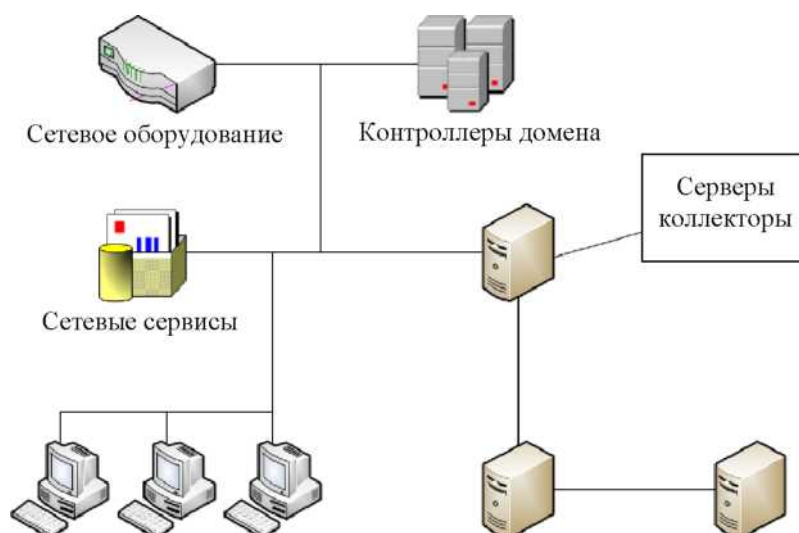
Рисунок 1 – Разработанная схема основных компонентов SIEM-системы для ООО «Теплогазстройсервис»
