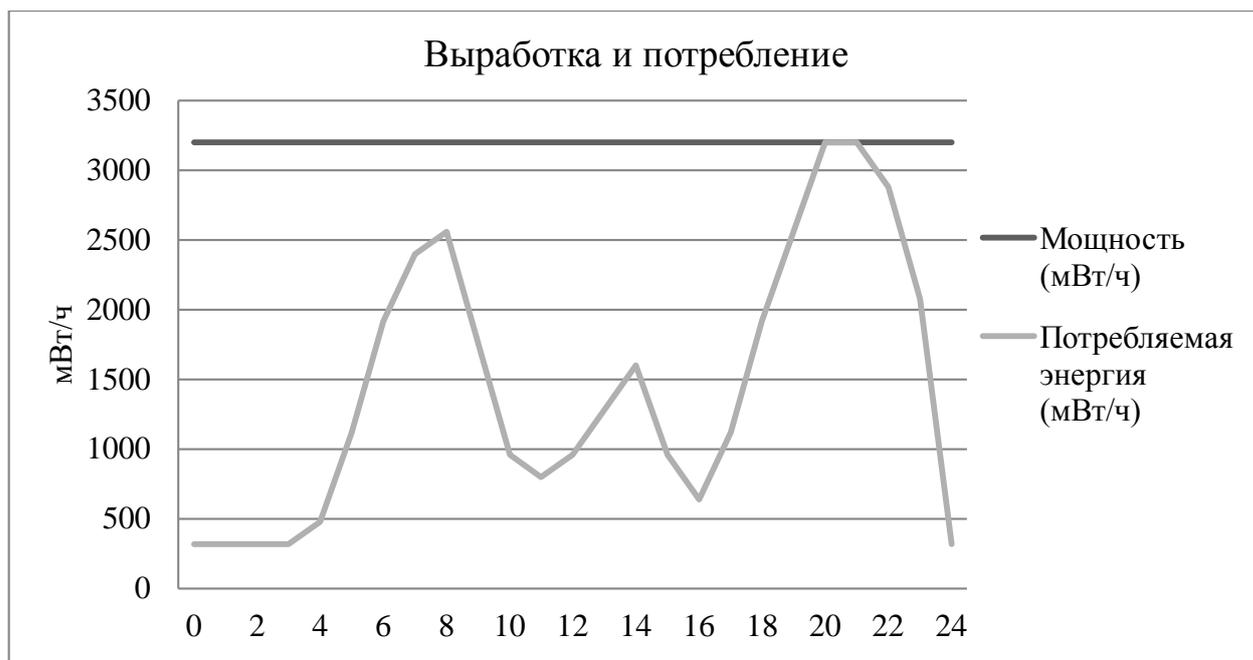
Рис. 1. График суточной выработки и потребления электроэнергии на Ленинградской АЭС
