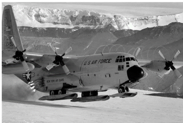
Рис. 2 Самолет Lockheed LC-130 с работающими ракетными двигателями.
