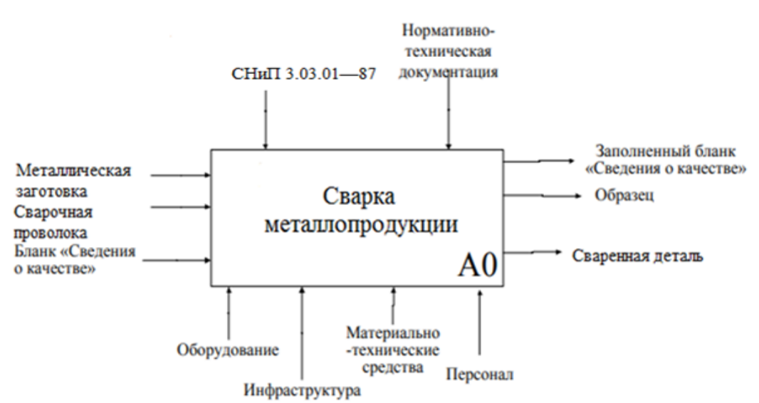
Рис. 1 – IDEF 0 - модель процесса сварки нулевого уровня
