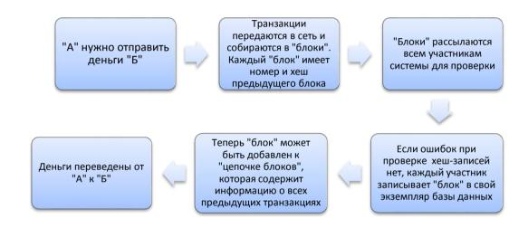
Рис. 1 – Схема работы технологии блокчейн
