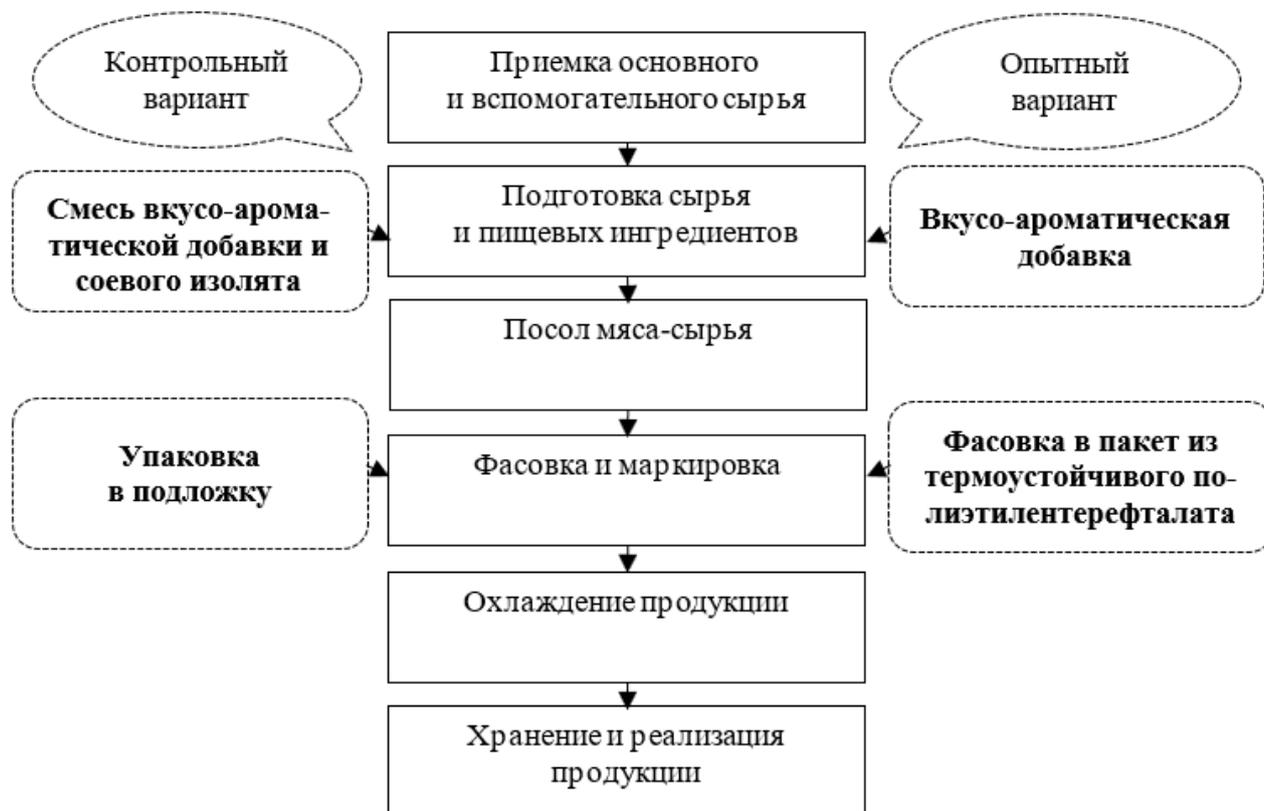
Рис. 1 – Технологическая блок-схема производства полуфабриката из мяса птицы в маринаде – сухой обсыпке (разработано автором)
